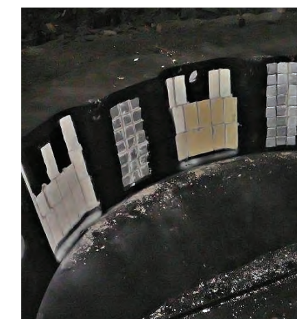
Tvarovky IZOCAST při formování. Odlitek pro lodní průmysl.
