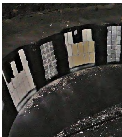
Tvarovky IZOCAS při formování. Odlitek pro ložní průmysl.
