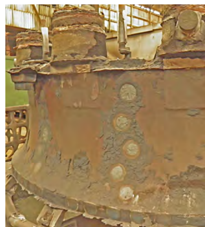
Objekt po odlití a odformování, na němž byly na určitých místech použity tvarovky IZOCAS.
